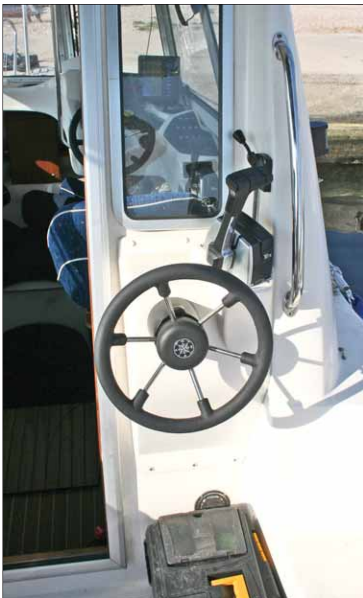
Timun s komandom motora i ručicom troling-ventila na palubi
