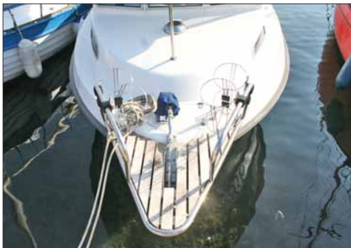
Odlično konstruiran baštun s držačima bokobrana koje treba okrenuti s vanjske strane
